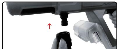
2. Asegúrese de que la manguera de entrada de agua esté conectada a la entrada de agua sin ningún espacio y afloje el anillo de tiro del conector de entrada de agua. La instalación de la entrada de agua estará completa.
